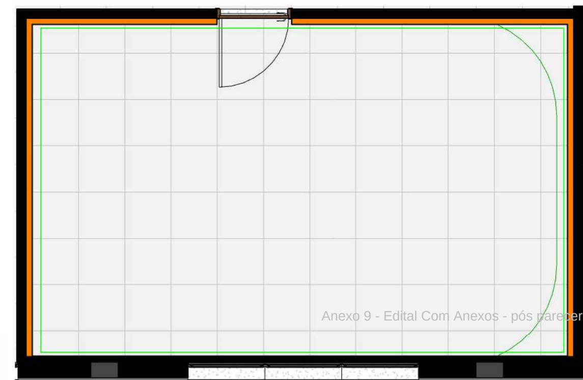
4 PLANTA DE PAGINAÇÃO DE PAREDE - STUDIO ESCALA 1 : 50
